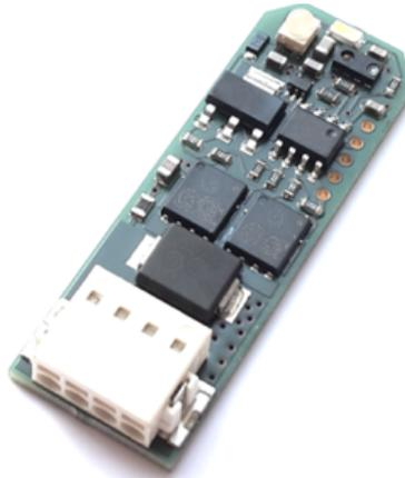
GSPW2P - 2-Kanal-Gestensensor für LED-Module
